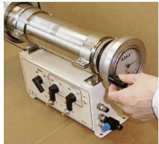
ストロークの変更で吐出容量を調整
